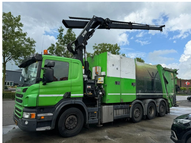
Scania P360 8X2 - HIAB 211BW-3 + FAUN VARIOPRESS - ...
