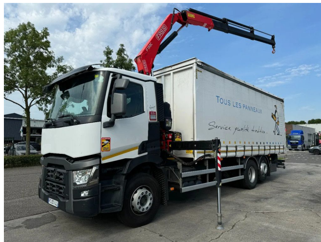
Renault C 380 6X2 FASSI F135 + REMOTE CONTROL
