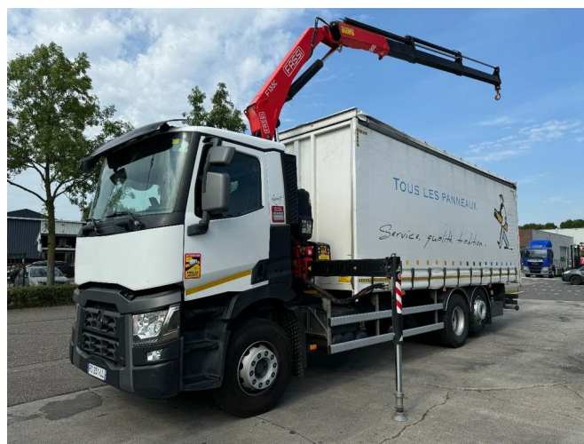
Renault C 380 6X2 FASSI F135 + REMOTE CONTROL
