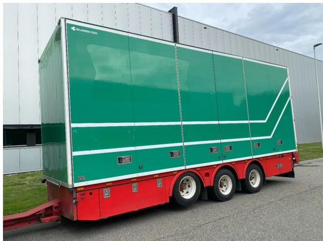
HFR KF22 // 3X BPW AXLE FRONT LIFT AXLE
