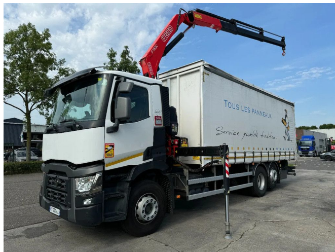
Renault C 380 6X2 FASSI F135 + REMOTE CONTROL
