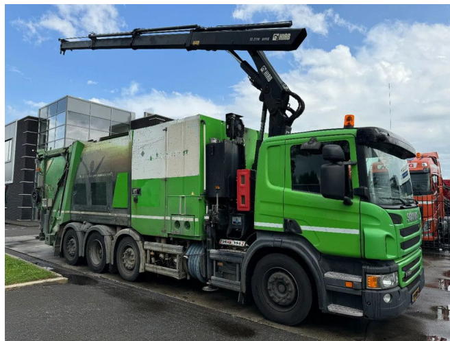
Scania P360 8X2 - HIAB 211BW-3 + FAUN VARIOPRESS - ...
